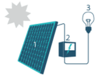
1. Zonnepaneel | 2. Omvormer | 3. Elektrische toestellen
